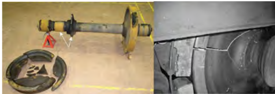
تصویر شماره (۱) - چرخ ترک‌خورده تصویر شماره (۲) - چرخ شکسته شده
